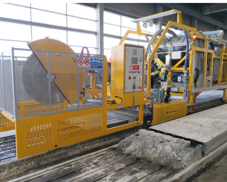
Sega a fresco automatica combinata con l'aspiratore calcestruzzo
