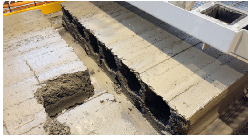
Qualità del taglio a fresco con sistema a ghigliottina
