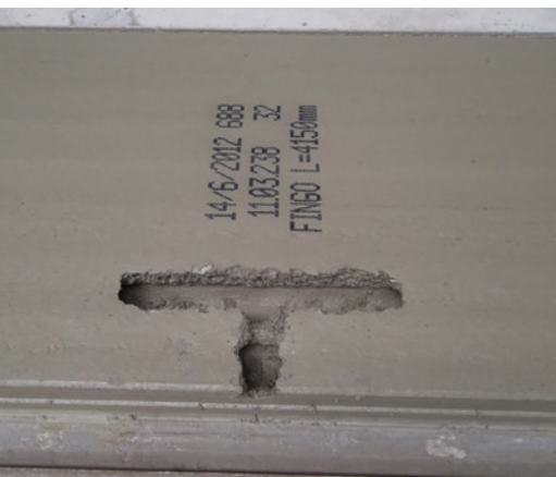
Tipiche lavorazioni a fresco realizzate con l'aspiratore calcestruzzo
