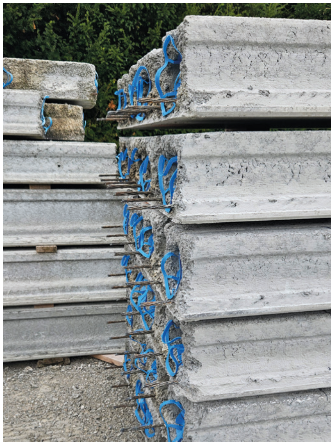
Pannelli alveolari con armature esposte
